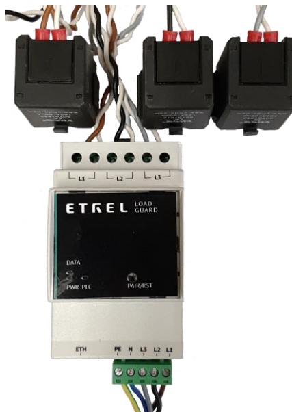
Slika 5: Load Guard s priključenimi tokovniki
