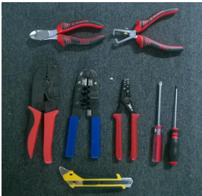
Afbeelding 42: Gebruikte uitrusting voor de installatie van een laadstation
