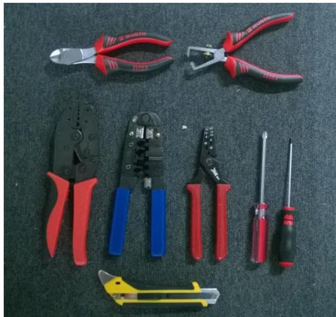
Imagen 42: Equipo utilizado para la instalación de la estación de carga
