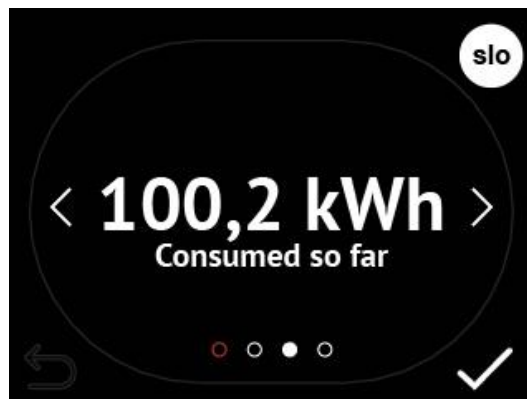
Obrázok 15: Príklad LCD obrazovky s údajmi o nabíjaní na nabíjacej stanici Etrel INCH
