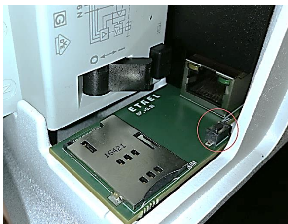
Slika 43: Gumb za ponovni zagon znotraj vzdrževalnega prostora
