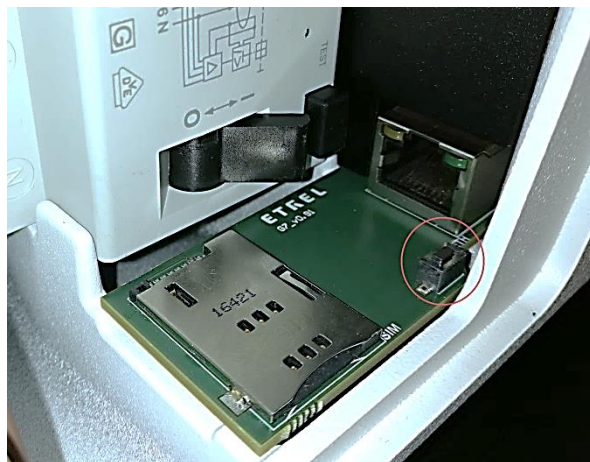
Figura 44: pulsante di reset all'interno dell'apertura di manutenzione
