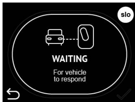
Abbildung 17: Die Ladestation wartet auf die Antwort des Elektrofahrzeugs und beginnt mit dem Laden
