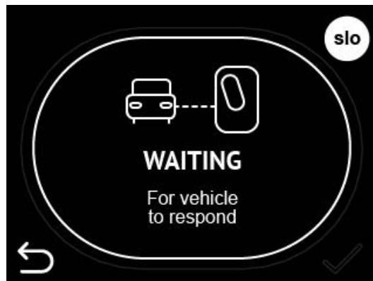
Figur 16: Ladestation venter på, at elbil svarer og begynder at oplade
