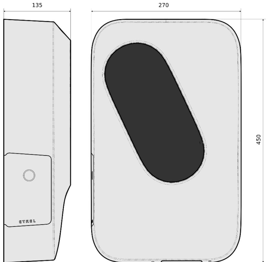
Figura 4: Dimensões da estação de carregamento
