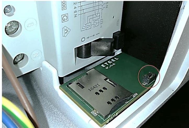
Figura 13: pulsante di reset all'interno dell'apertura di manutenzione
